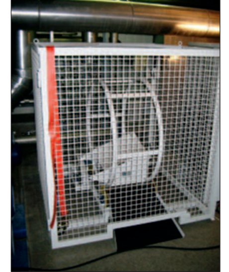
Abb. 5: Rühradmixer für die Homogenisierung des CO 2 -Extraktes
