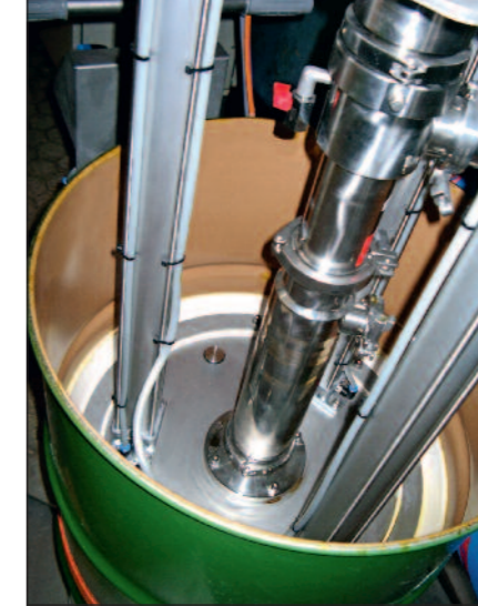
Abb. 4: Extrakteinsparung durch effektive Restentleerung
