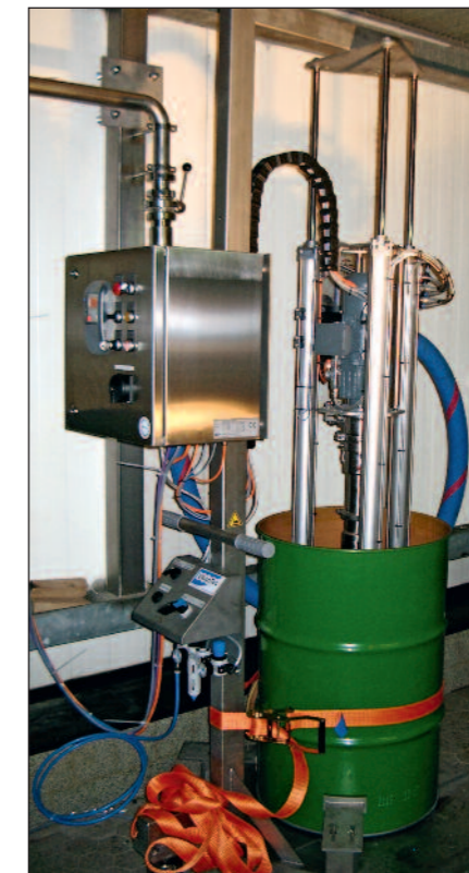
Abb. 1: Die Anlage besteht aus einem Gestell mit Pneumatik, einer Exzentrerschneckenpumpe mit Folgeplatte und einem parametrisierten Frequenzumformer mit Profibus-Modul.
